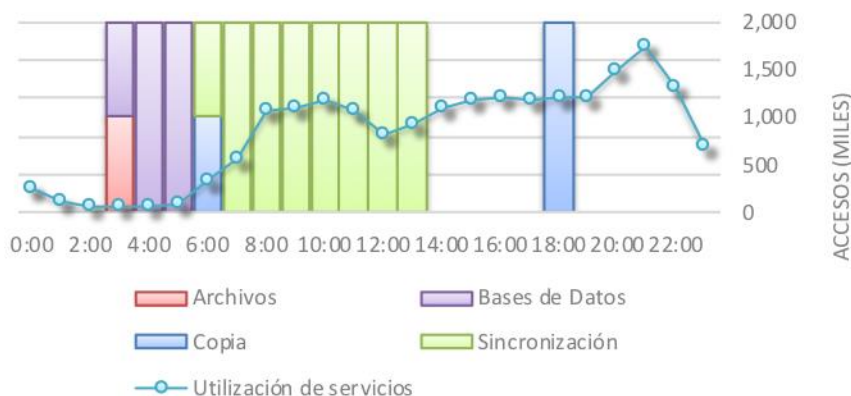
Fig. 4. Tiempos requeridos para realizar respaldos, versus utilización del servidor a diversas horas del día.
