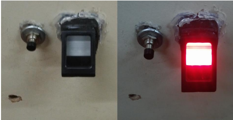
Fig. 8. Sensor de Huella Digital ZFM-20 y su pulsador. Inactivo (izquierda) y Sensor activo esperando huella (derecha).
