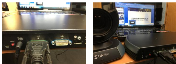
Imagen 1. Puerto DVI para conectar computadora a un equipo de videoconferencia H.323 y compartir con los usuarios remotos el contenido. Fuente: fotografías propias.
