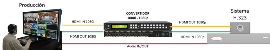
**Fig. 18.** Solución para conectar 1080i y 1080p
